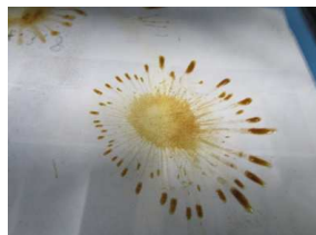
現状タンク内の錆状態 エア-抜きにて清掃を実施
